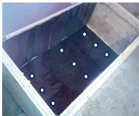
Abb.2: Messung der Temperaturverteilung mittels 9 Sensoren
